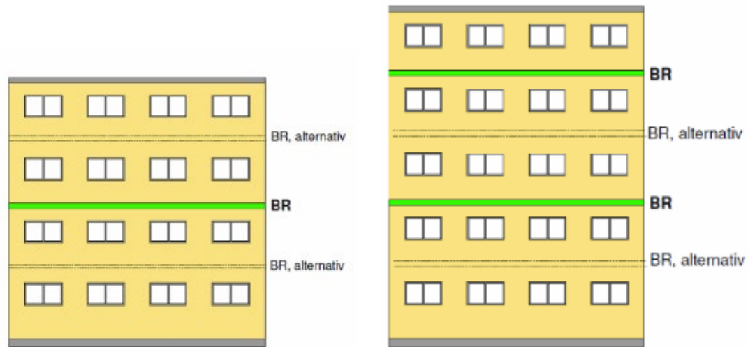
Brandsperren im Bereich der Geschossdecken
