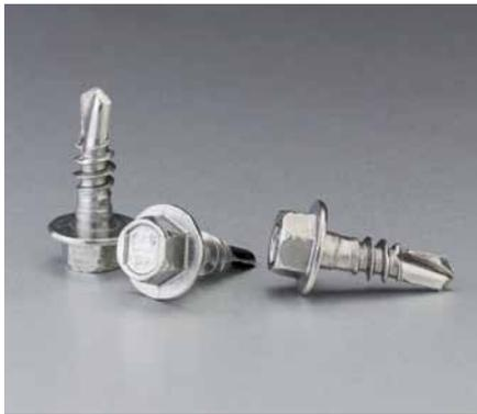
SLA5 - Einfache, sichere und schnelle Selbstbohrverbindung von Aluminium Unterkonstruktionen. Die komplett überarbeitete Selbstbohrschraube ist ganzheitlich aus Edelstahl A4 gefertigt. Durch optimierte Bohrspitze garantiert sie schnelle Setzungen und spart Arbeitszeit. Der große Kopf gewährleistet bestmögliche Querlast- sowie Überknüpfwerte.
