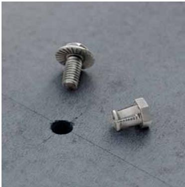
Der KEIL Anker wird spreizdruckfrei und formschlüssig im hinterschnittenen Bohrloch gesetzt. Eine temperatur- und witterungsunabhängige Montage erhöht die Planungssicherheit. Nachhaltigkeit durch die sichere Befestigung von dünnen Fassadenplatten. Vollständig demontierbar.
