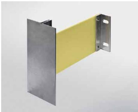
Wärmebrückenfreies Unterkonstruktionssystem VECO®-WDK-Phönix: Energetisch hocheffizient durch Einsatz eines Konsolenschwertes aus glasfaserverstärktem Kunststoff, keine punktuellen Wärmebrücken, geringere Dämmstärken, schlankere Fassadenkonstruktionen. Ressourcenschonend, kostenoptimiert, montagefreundlich.
