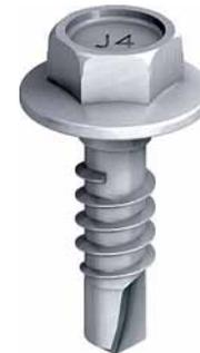
Zur Verbindung von Wandhaltern auf Tragprofilen präsentiert EJOT neue Edelstahlschrauben. Optimierte Fertigungsprozesse verleihen den Schrauben hochaggressive Bohrspitzen. Vergleichstests mit Wettbewerbsprodukten bestätigen eine deutlich verbesserte Bohrgeschwindigkeit in Aluminium. Erhältlich in A2 (JT4-3H/7-5,5x21) und A4 (JT9-3H/7-5,5x21).
