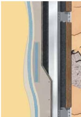
VHF im System Knauf Außenwand; hoher Witterungsschutz und konstruktiv getrennter Wärmeschutz. Nicht-Brennbarkeit (Baustoffklasse A) sämtlicher Komponenten. Hohe Lebensdauer und geringer Wartungsaufwand; optimale Balance von Heizwärme- und Kühlbedarf; vielseitig gestaltbar; erhöht den Wohnkomfort und die Wertigkeit des Gebäudes.
