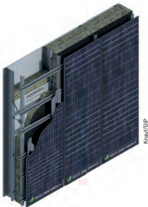
Das bewährte Knauf AQUAPANEL Außenwand System WM412C.de wurde mit GIP-Fassadenlösungen weiterentwickelt. Unter Beibehaltung des hohen Witterungs-, Schall- und Wärmeschutzes ermöglicht das hinterlüftete VECCO-2000 System nun auch die Integration von PV-Module zur Stromerzeugung. Gemeinsam ermöglichen wir grüne Energiegewinnung, individuelle Gestaltung und eine 100% recycelbare Fassade.
