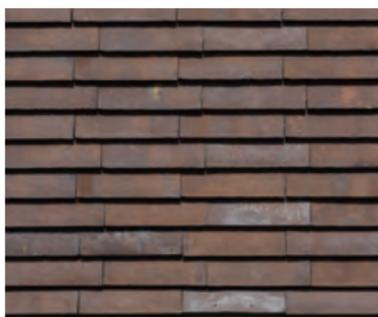
Der Cover-Ziegel C48 ist ein zu 100 % handgefertigter, handgestrichener Ziegel, der nicht vermauert, sondern an die Dach- oder Fassadenkonstruktion eines Gebäudes angeschraubt wird. Cover-Ziegel können weder durch Stürme gelockert noch manuell entfernt werden und sind somit vandalismussicher. Die Montage erfolgt einfach, schnell und witterungsunabhängig.
